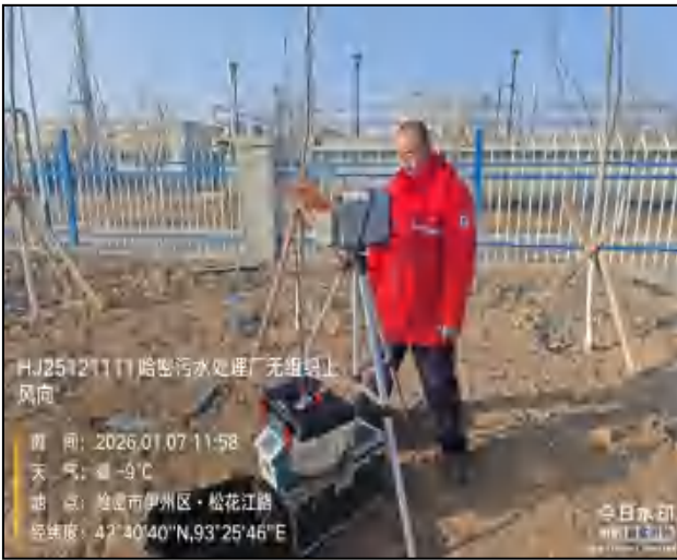
无组织废气现场监测
